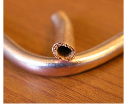
Şekil 16: Örnek ısı borusu
